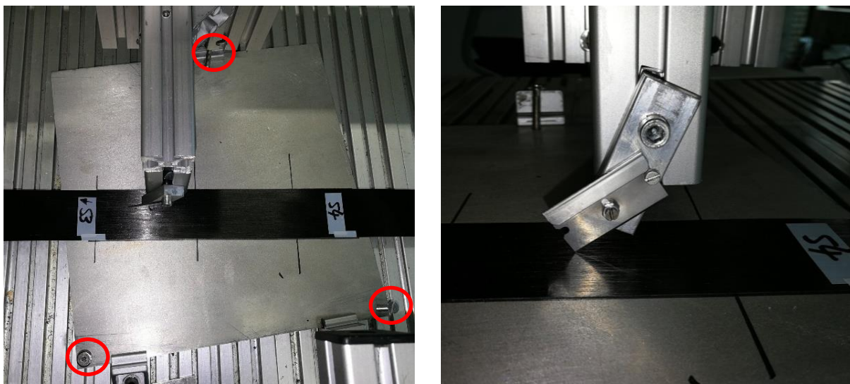
Bild 3.17: CNC gesteuerte Schneidevorrichtung basierend auf einem x-y-Scantisch, Draufsicht mit markierten Stellschrauben (links) und Schneidevorrichtung mit Rasiermesser Klinge (rechts)
