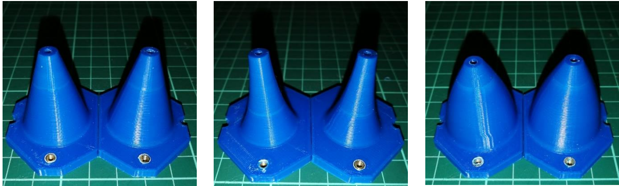
Bild 4.11: Fokussierungstrichter, hergestellt durch FDM, linear (links), exponentiell (Mitte) und parabolisch (rechts)
