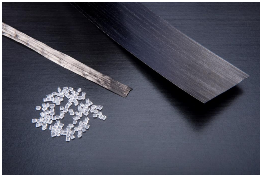
Bild 2.2: Thermoplastisches Granulat (links) und Kohlenstofffasern (Mitte), die Komponenten aus denen CFK-Tapes (rechts) hergestellt werden [9]
