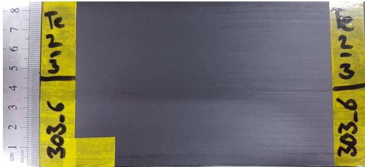
Bild 3.10: Präpariertes CFK-Tape mit Markierung aus Klebestreifen und notierter Identifikation
